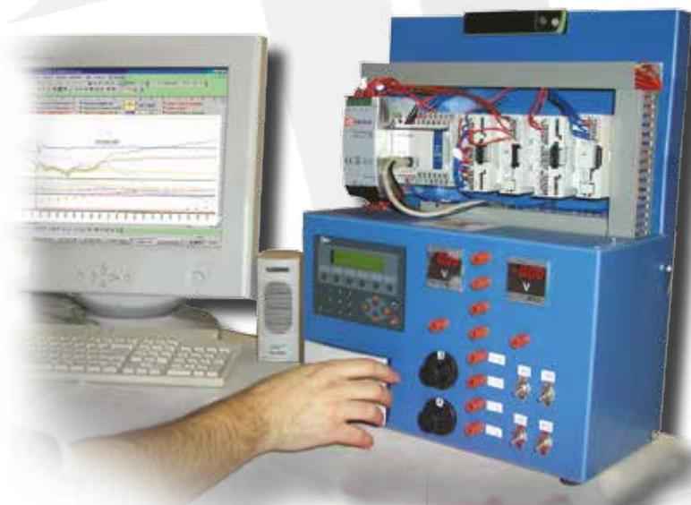
Per l'utilizzatore questo significa avere il controllo assoluto dell' impianto con la massima semplicità d'uso ovvero premere il pulsante Start e lasciare che il PLC faccia tutto il resto oppure collegarsi al regolatore tramite la rete internet aziendale per raccogliere tutti i dati necessari al monitoraggio dell'intero sistema.
