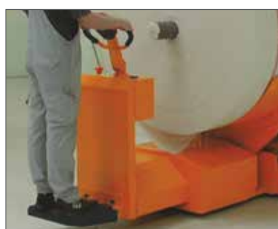
Ausführung mit Mitfahrplattform Execution with operator's platform
