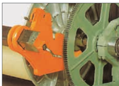
Option: Höhenverstellbare Rohrgreifern z.B. im Fall von Universallagerung.
