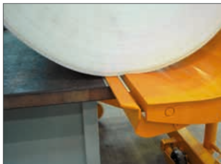
Option: Abklappbare Muldenkante. Sie erleichtert das Abrollen bei schweren und hartgewickelten Rollen Option: Hinged cradle front edge, enables easy rolling over heavy and hard-wound rolls
