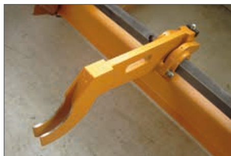
Mitteltragarm (M) für Zwillingskettbäume Central carrying arm for twin beams
