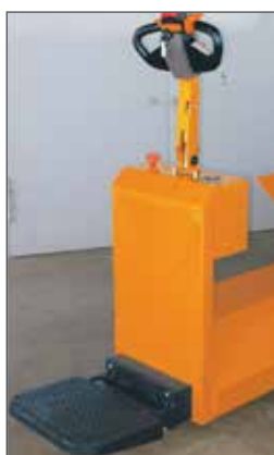
Option: Klappbare Mitfahrplattform Option: Foldable operators platform
