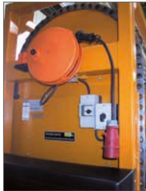
Automatischer Kabelaufroller Automatic cable winder
