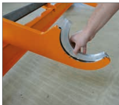
Ausführung mit Adapter für unterschiedliche Rohrdurchmesser. Execution with adapter for different tube diameters.
