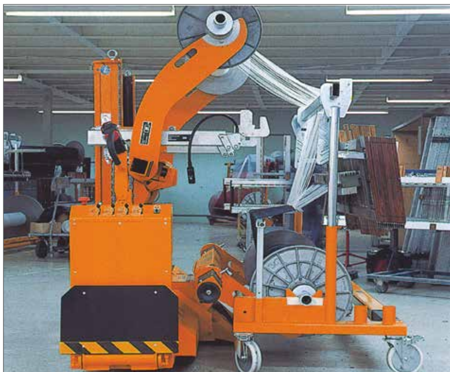
Übernahme der Doppelkette vom Lagerwagen Take over of double warp from storing trolley
