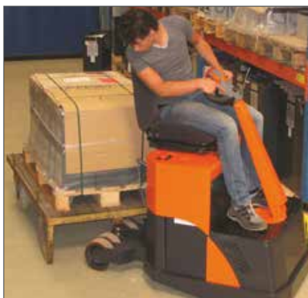
Anheben mit Hubkugel Lifting with ball head
