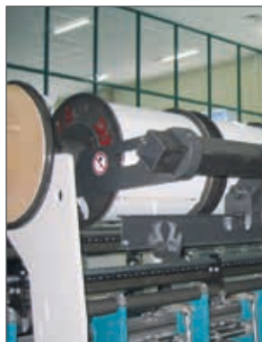
Option: Zusatzgreifer Einlegen der Kettbäume mit Greifern
