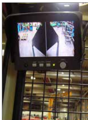
Kamerasystem mit geteiltem Monitor zur exakten Kontrolle der Lastaufnahme Camera system with splitted screen for exact positioning of grippers and warp beams
