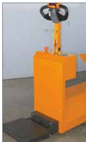
Klappbare Mittfahrplattform. Foldable operators platform.
