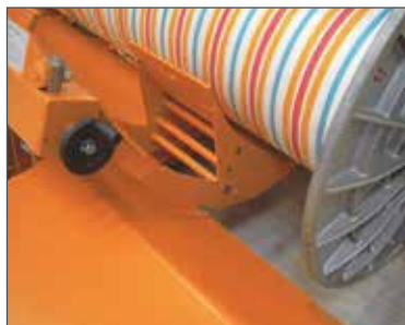
Reduziermulde für teilbewickelte Kettbäume. Adaptors for partly wound warp beams.
