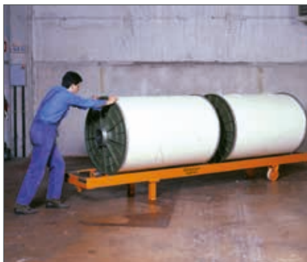
Ausrichten der Teilkettbäume durch Drehen und Verschieben Positioning of sectional warp beams by turning and moving
