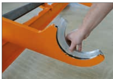
Option: Adapter für unterschiedliche Rohr-Durchmesser.
