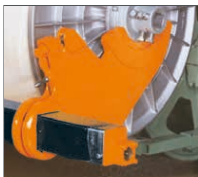
Ausführung mit höhenverstellbaren Rohrgreifern, z.B. für Steckachsen. Execution with tube grippers adjustable in height, e.g. for beam drive adapters.
