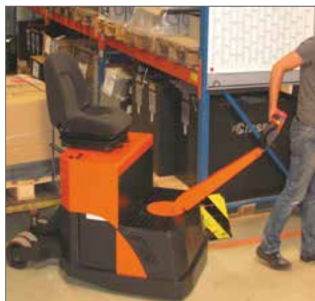
Verwendung als Gehgerät Usable as walkie-tractor
