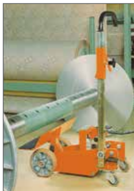
quer unter den Kettbaum fahren und freiheben... driving crosswise beneath the warp beam and lifting it up...
