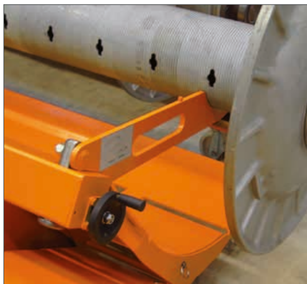
Ausschwenkbare Rohrgreifer für leere Kettbäume. foldable grippers for empty warp beams.
