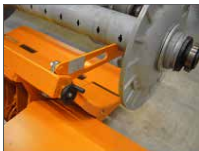
Zusatzgreifer für leere Kettbäume. Additional grippers for empty warp beams.
