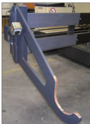
Kamerasystem mit geteiltem Monitor zur exakten Kontrolle der Lastaufnahme Camera system with splitted screen for exact positioning of grippers and warp beams
