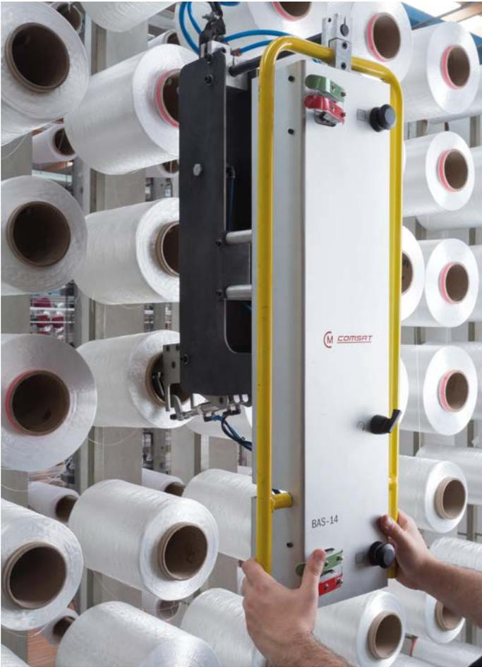
El manipulador de bobinas COMSAT BAS-14 permite cargar bobinas pesadas fácilmente y sin esfuerzo por parte del operario. Sistema de equilibrado neumático montado sobre guías sin mantenimiento, con la posibilidad de instalar una unidad en cada lateral de cualquier tipo de fileta. Disponibilidad de diferentes tipos y tamaños de pinza para la adaptación a las distintas bobinas.
