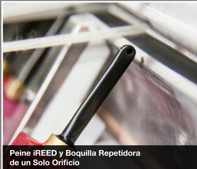
**Peine iREED y Boquilla Repetidora de un Solo Orificio**
